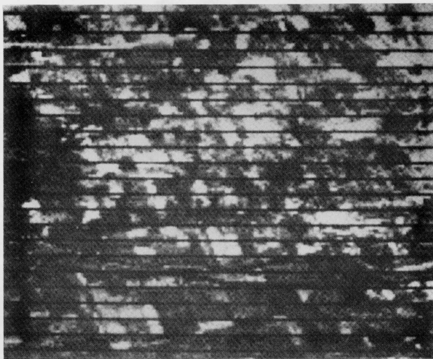
Figura II-2. Efecto de líneas defectuosas en la imagen.
